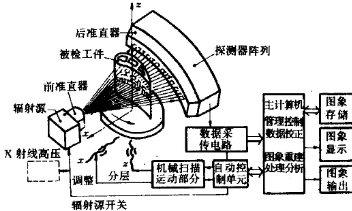
图 3 ICT 结构工作原理简图
